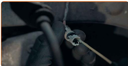
**26** Collegare il connettore e fissare il cablaggio del sensore
