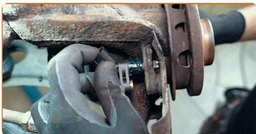
**23** Avvita gli elementi di fissaggio del sensore ABS
