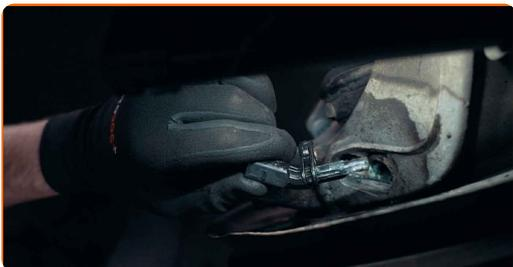
**18** Rimuovere il cablaggio del sensore, qualora sia necessario
