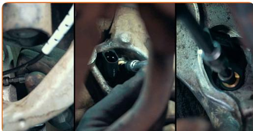
**24** Serrare gli elementi di fissaggio con una chiave dinamometrica alla coppia raccomandata dal produttore
