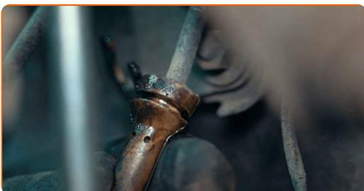
**19** In alcuni casi, la corrosione può rendere difficile la rimozione del sensore
