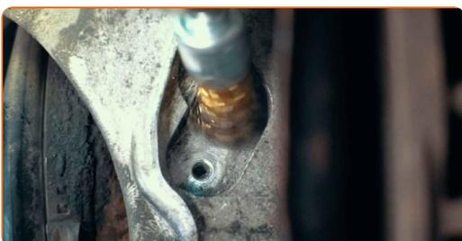
**21** Quindi lubrificare la superficie di montaggio del nuovo sensore
