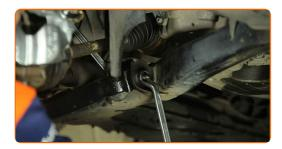
Stringi gli elementi di fissaggio posteriore collegando il braccio al telaio. Utilizza una chiave combinata N°21. Utilizza una chiave a bussola N°21. Usa una chiave dinamometrica. Serralo fino allo coppia di torsione di 110 Nm. +120°
