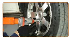
Rimettere il veicolo per terra e, lavorando in ordine incrociato, serrare i bulloni di fissaggio delle ruote. Usa la chiave a bussola per dadi cerchio ruota n.19. Usa una chiave dinamometrica. Serralo fino allo coppia di torsione di 180 Nm.
