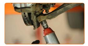
Scollegare il braccio di controllo inferiore dal fuso a snodo dello sterzo. Usa un estrattore del giunto sferico.
