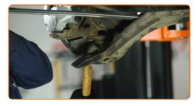
Svita gli elementi di fissaggio posteriori che collegano il braccio di sospensione al sottotelaio. Utilizza una chiave combinata N°21. Utilizza una chiave a bussola N°21. Usa una chiave a cricchetto. Usa un giramaschi.
