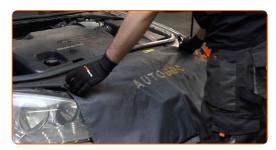
Rimuovere la copertura del motore.
