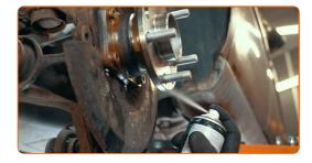
Applicare un prodotto trattante sul connettore del sensore ABS. Usi uno spray per dispositivi elettronici.
