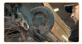
Pulisci la sede di montaggio del cuscinetto del mozzo. Usa una spazzola metallica. Usa lo spray WD-40.
