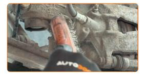
Sgancia il cavo del freno di stazionamento. Usa delle tenaglie. Usa un piede di porco.
