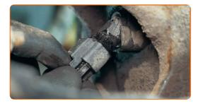
Pulisci l'elemento di fissaggio del mozzo della ruota. Usa una spazzola metallica. Usa lo spray WD-40.
