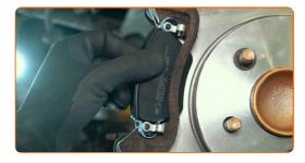
Montare la pinza del freno e fissarla. Utilizza una chiave a bussola N°13. Usa una chiave dinamometrica. Serralo fino allo coppia di torsione di 30 Nm.
