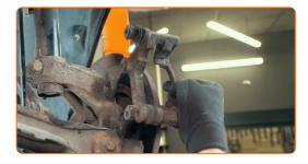
Pulire l'elemento di fissaggio del disco del freno. Usa una spazzola metallica. Usa lo spray WD-40.
