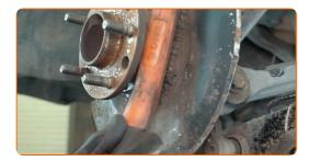
Svitare i bulloni del mozzo della ruota. Usa la chiave Torx T50. Usa un giramaschi.
