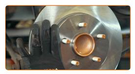
Avvitare l'elemento di fissaggio del disco del freno.
