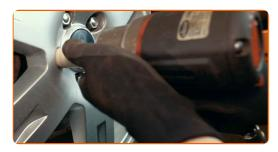
Rimettere il veicolo per terra e, lavorando in ordine incrociato, serrare i bulloni di fissaggio delle ruote. Usa la chiave a bussola per dadi cerchio ruota n.19. Usa una chiave dinamometrica. Serralo fino allo coppia di torsione di 90 Nm.
