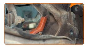
Scollega il connettore del sensore di velocità ABS.
