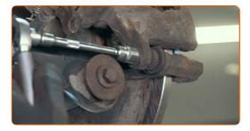
Installa il cavo del freno di stazionamento nella staffa della pinza del freno. Usa delle tenaglie. Usa un piede di porco.
