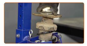
Serrare la vite dell'asta pistone supporto ammortizzazione. Usa una chiave HEX N.H6. Utilizza una chiave combinata N°19. Usa una chiave dinamometrica. Serralo fino allo coppia di torsione di 30 Nm.
