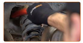
Svita l'elemento di fissaggio inferiore del supporto di ammortizzazione. Utilizza una chiave a bussola N°21. Usa una chiave a cricchetto. Usa un giramaschi.
