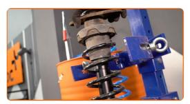
19 Installare il supporto di ammortizzazione nell'arco passaruota.
