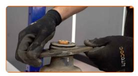
Installare l'elemento di montaggio del supporto di ammortizzazione superiore.
