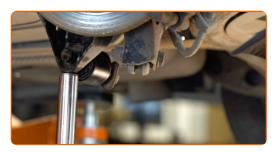
Serrare il perno di fissaggio inferiore del supporto di ammortizzazione. Utilizza una chiave a bussola N°21. Usa una chiave dinamometrica. Serralo fino allo coppia di torsione di 140 Nm.
