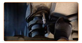
Installa gli elementi di fissaggio inferiori del puntone dell'ammortizzatore.
