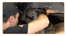
Serrare il fissaggio superiore del supporto di ammortizzazione. Utilizza una chiave a bussola N°13. Usa una chiave dinamometrica. Serralo fino allo coppia di torsione di 56 Nm.
