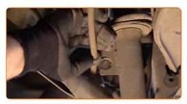
Svitare il perno di fissaggio superiore del supporto di ammortizzazione. Utilizza una chiave a bussola N°13. Usa una chiave a cricchetto.
