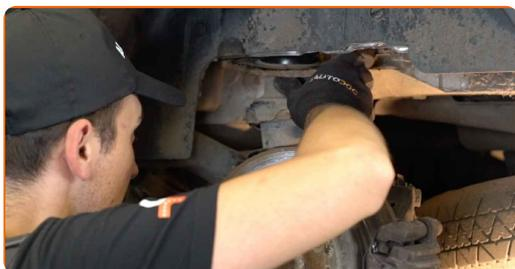
**20** Serrare il fissaggio superiore del supporto di ammortizzazione. Utilizza una chiave a bussola N°13. Usa una chiave dinamometrica. Serralo fino allo coppia di torsione di 56 Nm.
