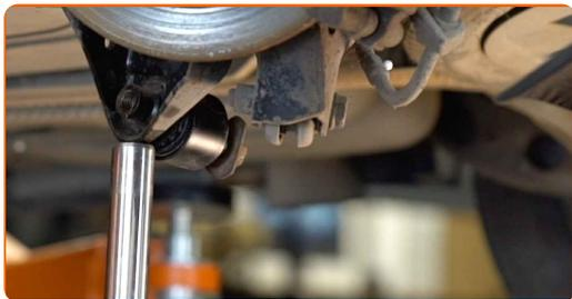
**23** Serrare il perno di fissaggio inferiore del supporto di ammortizzazione. Utilizza una chiave a bussola N°21. Usa una chiave dinamometrica. Serralo fino allo coppia di torsione di 140 Nm.
