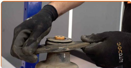
**15** Installare l'elemento di montaggio del supporto di ammortizzazione superiore.
