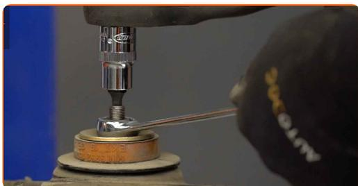
**14** Rimuovere l'elemento di montaggio superiore.
