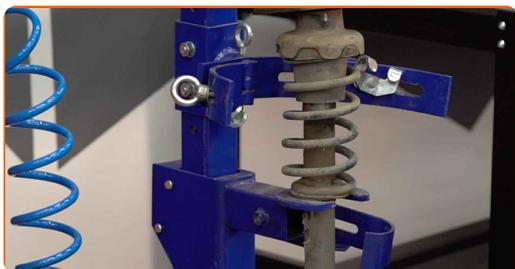
Sostituzione: supporto ammortizzatore - MINI Hatchback (R56). Gli esperti di AUTODOC raccomandano:
