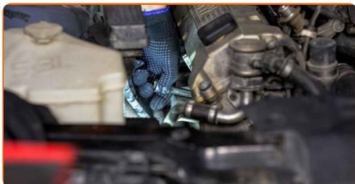
Sostituzione: candele di accensione - MINI Hatchback (R50, R53). Gli esperti di AUTODOC raccomandano:
