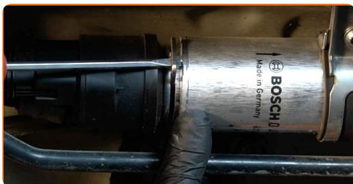
**4** Allenta i morsetti di fissaggio del tubo del filtro carburante. Usa un giravite piatto.
