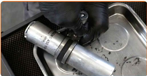
**9** Rimuovere la staffa di fissaggio del filtro carburante.
