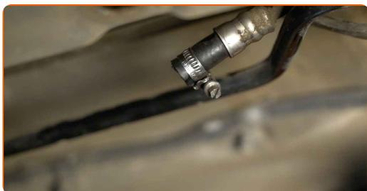
**8** Svitare i bulloni della staffa di fissaggio del filtro carburante. Usa la chiave Torx T 40. Usa una chiave a cricchetto.
