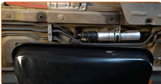
**3** Rimuovi l'anello elastico della clip di ritenuta del regolatore di pressione del carburante. Usa un giravite piatto.
