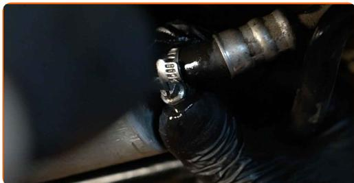
**17** Pulire la staffa di montaggio del filtro carburante. Usa un detergente spray multiuso.
