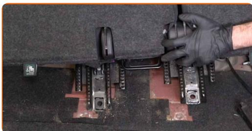
**18** Allentare i fermi sul coperchio di accesso al modulo della pompa del carburante. Usa un cacciavite Phillips.
