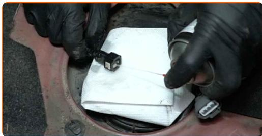
**29** Collegare il tubo di mandata del carburante al modulo della pompa del carburante.
