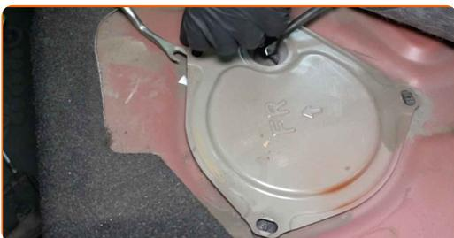
**20** Pulire la sede di montaggio del modulo della pompa del carburante. Usa un detergente spray multiuso.
