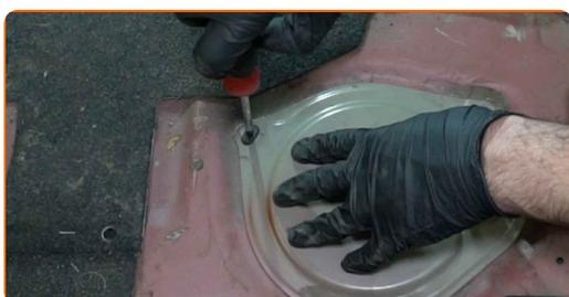
**39** Reinstallare le guide di scorrimento del sedile posteriore insieme allo schienale.
