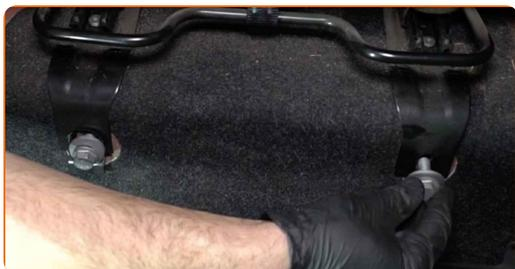
**41** Avvitare gli elementi di fissaggio anteriori delle guide di scorrimento del sedile posteriore. Utilizza una chiave a bussola N°17. Usa una chiave a cricchetto.
