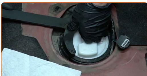
**28** Pulire il connettore del tubo di mandata del carburante. Usa un detergente spray multiuso.
