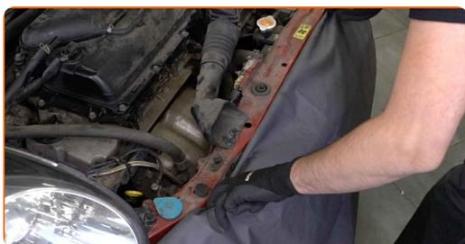
**3** Scollegare il morsetto del cavo di terra dalla batteria. Utilizza una chiave a bussola N°10. Usa una chiave a cricchetto.
