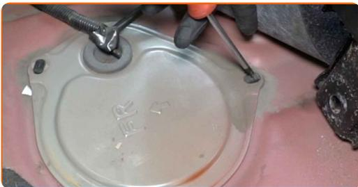
**19** Rimuovere il coperchio di accesso al modulo della pompa del carburante. Usa uno strumento per estrazione clip.
