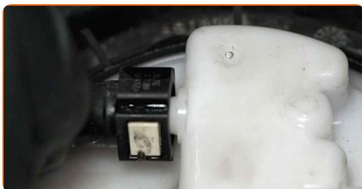
**30** Collegare il connettore del modulo della pompa del carburante.
