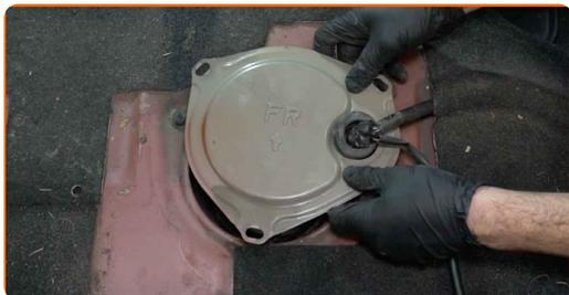
**38** Girare i fermi del coperchio del modulo della pompa del carburante per bloccarlo in posizione. Usa un cacciavite Phillips.
