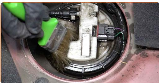
**21** Staccare il connettore del modulo della pompa del carburante.
