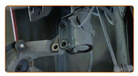
Rimuovere il fuso a snodo dello sterzo insieme al mozzo della ruota.
