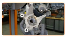
Estrarre il mozzo della ruota dal fuso a snodo. Usa un set di montaggio/smontaggio cuscinetti e boccole.
