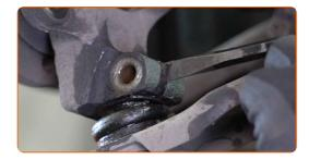
Separare il giunto sferico dal fuso a snodo dello sterzo.
