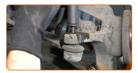
Separare l'estremità del tirante dal fuso a snodo dello sterzo. Usa un estrattore del giunto sferico.
