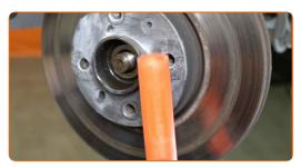
Svitare gli elementi di fissaggio del disco del freno. Usa la chiave Torx T40. Usa un cacciavite a percussione.
