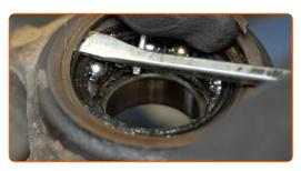
Smontare l'anello interno del cuscinetto che rimane sul mozzo. Usa un set di montaggio/smontaggio cuscinetti e boccole. Usare un separatore cuscinetti.
