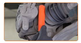
Svitare gli elementi di fissaggio del supporto della pinza del freno. Utilizza una chiave a bussola N°17. Usa una chiave a cricchetto.
