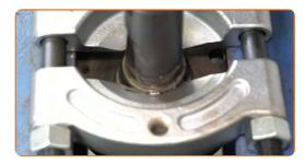
Premere il cuscinetto del mozzo della ruota. Usa un set di montaggio/smontaggio cuscinetti e boccole.
