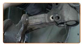
Fissare il puntone di sospensione sul fuso a snodo dello sterzo.
