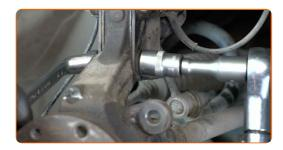
58 Installare il sensore ABS
