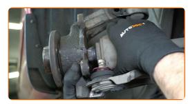
Collegare il giunto sferico al fuso a snodo dello sterzo.
