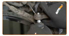
Serra il bullone di fissaggio che collega la testina tirante al fuso a snodo. Utilizza una chiave a bussola N°14. Usa una chiave dinamometrica. Serralo fino allo coppia di torsione di 35 Nm.
