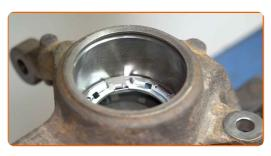
Inserire a pressione il nuovo cuscinetto nel fuso a snodo. Usa un set di montaggio/smontaggio cuscinetti e boccole.
