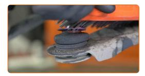
Installare il fuso a snodo dello sterzo assemblato con il mozzo della ruota.
