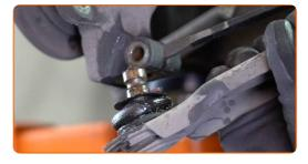
Estrarre l'assale di trasmissione a velocità costante (assale CV) dal fuso a snodo dello sterzo, sollevarlo e legarlo alla carrozzeria.
