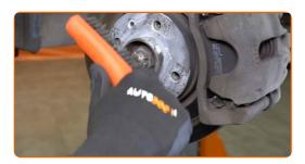
Svita gli elementi di fissaggio che collegano l'albero di trasmissione al mozzo della ruota. Utilizza una chiave a bussola N°30. Usa un giramaschi.
