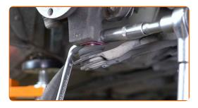
Serra gli elementi di fissaggio inferiori che collegano l'ammortizzatore al fuso a snodo. Utilizza una chiave combinata N°17. Utilizza una chiave a bussola N°18. Usa una chiave dinamometrica. Serralo fino allo coppia di torsione di 116 Nm.
