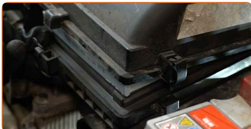
11 Bloccare i fermi dell'alloggiamento del filtro dell'aria.
