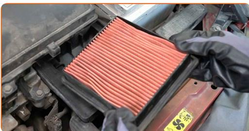
8 Pulire l'alloggiamento del filtro dell'aria.
