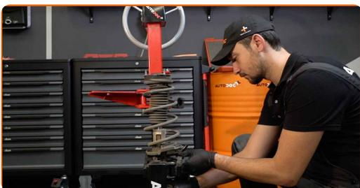
Sostituzione: ammortizzatore a molla - Nissan Micra K11. Gli esperti di AUTODOC raccomandano:
