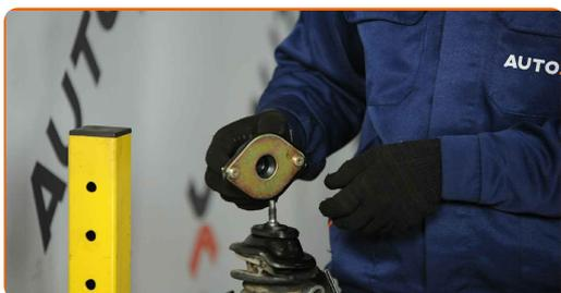
**31** Stringi l'elemento di fissaggio superiore del supporto di ammortizzazione. Utilizza una chiave combinata N°14. Usa una chiave regolabile. Usa una chiave dinamometrica. Serralo fino allo coppia di torsione di 40 Nm.
