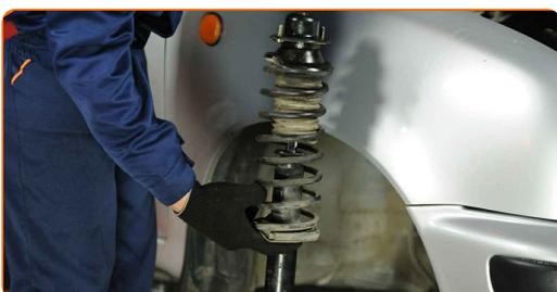
**17** Montare il supporto di ammortizzazione sul dispositivo speciale per la compressione delle molle.
