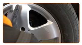
Stringere la vite del dado di fissaggio del mozzo della ruota. Usa la chiave Torx T40. Usa una chiave dinamometrica. Serralo fino allo coppia di torsione di 11 Nm.
