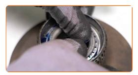
Installare il paraolio del cuscinetto della ruota. Usa un set di montaggio/smontaggio cuscinetti e boccole.
