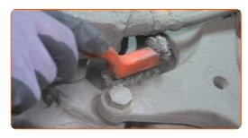
Svitare gli elementi di fissaggio del supporto della pinza del freno. Utilizza una chiave a bussola N°18. Usa una chiave a cricchetto.
