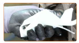
Pulire il sensore ABS. Usare una spazzola pulente in nylon. Usa un detergente spray multiuso.
