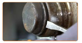
Allentare la vite del dado di fissaggio del mozzo della ruota. Usa la chiave Torx T40. Usa una chiave a cricchetto.
