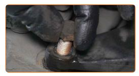
Serrare gli elementi di fissaggio del supporto della pinza del freno. Utilizza una chiave a bussola N°18. Usa una chiave dinamometrica. Serralo fino allo coppia di torsione di 115 Nm.
