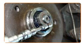
Installare il coperchio del cuscinetto del mozzo. Usa un set di montaggio/smontaggio cuscinetti e boccole.
