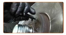
Stringere gli elementi di fissaggio del disco del freno. Usa una chiave HEX N.H5. Usa una chiave dinamometrica. Serralo fino allo coppia di torsione di 10 Nm.
