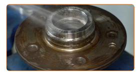
Installare gli anelli esterni dei nuovi cuscinetti della ruota. Usa un set di montaggio/smontaggio cuscinetti e boccole.
