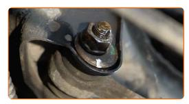
Svitare l'elemento che fissa il braccio al telaio di base. Usa la chiave XZN n.12. Utilizza una chiave a bussola N°19. Usa un giramaschi.
