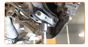
Fissare l'elemento di fissaggio del braccio sul telaio di base. Usa la chiave XZN n.12. Utilizza una chiave a bussola N°19. Usa una chiave dinamometrica. Serralo fino allo coppia di torsione di 70 Nm.
