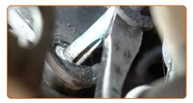
Svita gli elementi di fissaggio che collegano il braccio di sospensione allo snodo posteriore. Utilizza una chiave combinata N°16. Usa una chiave HEX N.H5. Usa una chiave a cricchetto.
