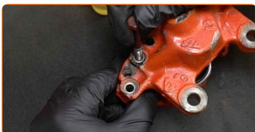
**38** Serrare gli elementi di fissaggio che collegano le due parti della pinza. Utilizza una chiave a bussola N°14. Usa una chiave dinamometrica. Serralo fino allo coppia di torsione di 35 Nm.
