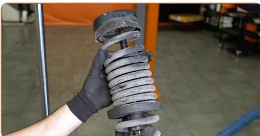
Sostituzione: molle di sospensione - MERCEDES-BENZ W124 Coupe (C124).
