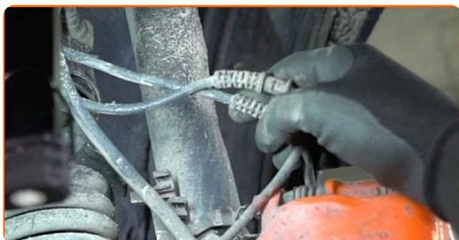
**11** Svitare gli elementi di fissaggio inferiori dell'ammortizzatore. Utilizza una chiave a bussola N°19. Usa una chiave a cricchetto.
