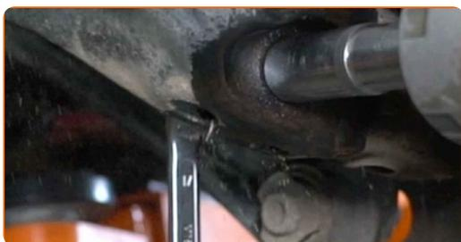
**13** Svitare il fissaggio superiore dell'ammortizzatore.
