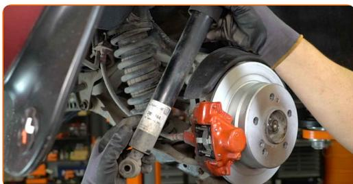
**17** Pulisci le sedi di montaggio dell'ammortizzatore. Usa una spazzola metallica. Usa un detergente spray multiuso.
