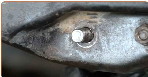
**22** Per serrare correttamente i fissaggi, è necessario sollevare i componenti della sospensione fino a raggiungere la relativa posizione di lavoro.
