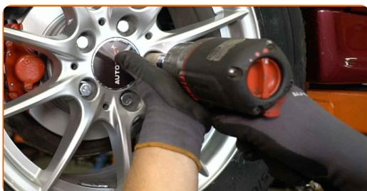
**29** Rimettere il veicolo per terra e, lavorando in ordine incrociato, serrare i bulloni di fissaggio delle ruote. Usa la chiave a bussola per dadi cerchio ruota n.17. Usa una chiave dinamometrica. Serralo fino allo coppia di torsione di 110 Nm.
