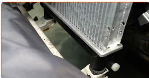
**24** Installare le clip di fissaggio superiori del radiatore del motore.
