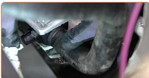
**30** Serrare la fascetta del tubo flessibile inferiore del liquido refrigerante. Utilizza una chiave a bussola N°7. Usa una chiave a cricchetto.
