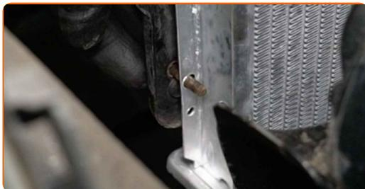
**28** Avvitare gli elementi di fissaggio dell'alloggiamento della ventola. Utilizza una chiave combinata N°10. Utilizza una chiave a bussola N°10. Usa una chiave a cricchetto.
