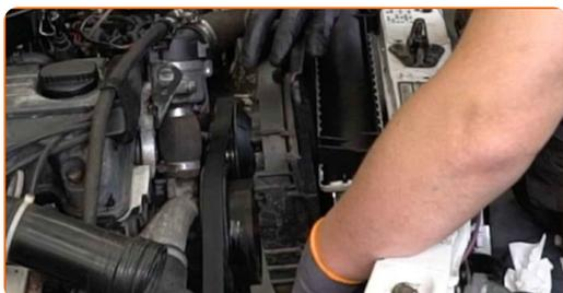
**26** Fissare le clip superiori per l'alloggiamento della ventola del radiatore.
