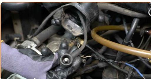
**9** Svitare gli elementi di fissaggio dei terminali della bobina di accensione. Utilizza una chiave a bussola N°10. Usa una chiave a cricchetto.
