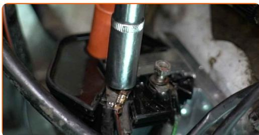
**18** Collegare il cavo ad alta tensione alla bobina di accensione.
