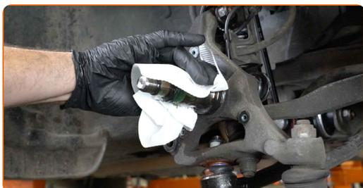
**46** Installa la lamiera di protezione del disco freno.
