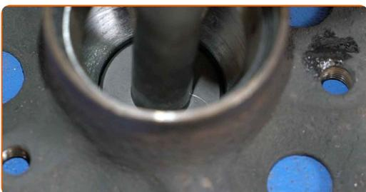
**31** Rimuovere la gabbia interna del cuscinetto dal mozzo della ruota. Usa un estrattore universale a tre bracci. Usa un set di montaggio/smontaggio cuscinetti e boccole.
