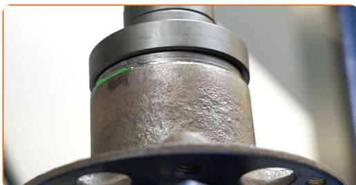
**41** Installare la nuova guarnizione OR (anello O-Ring). Usare un set di montaggio/smontaggio cuscinetti e boccole.
