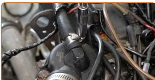
**10** Scollegare il tubo flessibile del vaso di espansione dall'alloggiamento del termostato.
