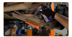
Abbassa la traversa posteriore della sospensione. Usa un piede di porco.
