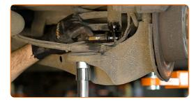
Smonta la parte inferiore dell'ammortizzatore. Usa un piede di porco.
