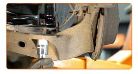
Stringi l'elemento di fissaggio inferiore dell'ammortizzatore. Utilizza una chiave a bussola N°21. Usa una chiave dinamometrica. Serralo fino allo coppia di torsione di 133 Nm.
