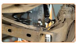
Collega la parte inferiore dell'ammortizzatore. Monta il bullone di fissaggio. Usa un piede di porco.
