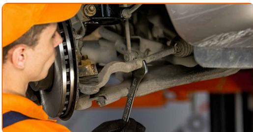
**9** Pulisci l'elemento di fissaggio che collega le testine tiranti al fuso a snodo. Usa una spazzola metallica. Usa lo spray WD-40.
