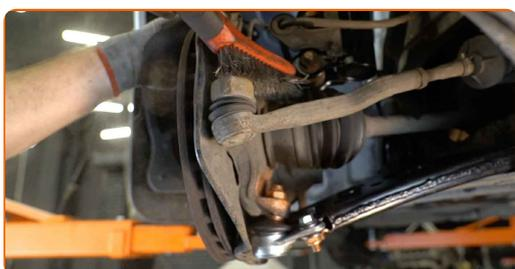
**10** Svitare il dado di attacco del gambo al fuso a snodo. Utilizza una chiave a bussola N°21. Usa una chiave a cricchetto.
