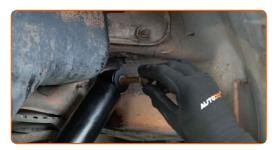
Stringi l'elemento di fissaggio inferiore dell'ammortizzatore. Utilizza una chiave a bussola N°21. Usa una chiave dinamometrica. Serralo fino allo coppia di torsione di 130 Nm.
