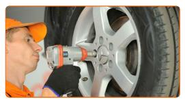
Rimettere il veicolo per terra e, lavorando in ordine incrociato, serrare i bulloni di fissaggio delle ruote. Usa la chiave a bussola per dadi cerchio ruota n.17. Usa una chiave dinamometrica. Serralo fino allo coppia di torsione di 130 Nm.
