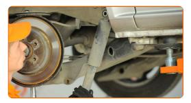
Pulisci le sedi di montaggio dell'ammortizzatore. Usa una spazzola metallica. Usa lo spray WD-40.
