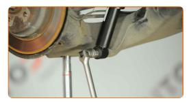
Serrare il perno di fissaggio superiore dell'ammortizzatore. Utilizza una chiave a bussola N°21. Usa una chiave dinamometrica. Serralo fino allo coppia di torsione di 130 Nm.
