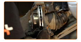
Serrare il sostegno pinza freno. Utilizza una chiave a bussola N°21. Usa una chiave dinamometrica. Serralo fino allo coppia di torsione di 172 Nm.
