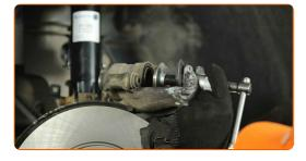
Montare la pinza del freno e fissarla.
