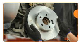
Serrare l'attacco del disco freno. Usa la chiave Torx T30. Usa una chiave dinamometrica. Serralo fino allo coppia di torsione di 18 Nm.
