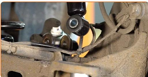
**17** Collega la parte inferiore dell'ammortizzatore. Monta il bullone di fissaggio.
