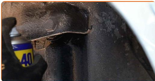
**8** Avvita l'elemento di fissaggio inferiore dell'ammortizzatore. Utilizza una chiave a bussola N°21. Usa un piede di porco. Usa un giramaschi.
