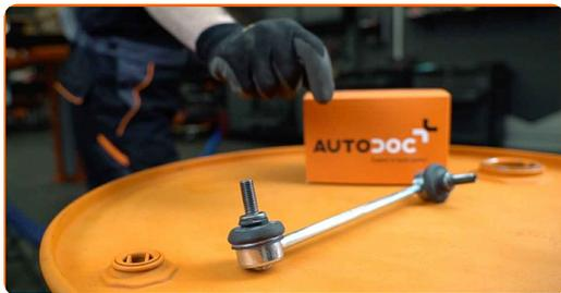
**11** Serra gli elementi di fissaggio che collegano il tirante della barra stabilizzatrice al puntone dell'ammortizzatore. Utilizza una chiave a bussola N°16. Utilizza una chiave combinata N°16. Usa una chiave dinamometrica. Serralo fino allo coppia di torsione di 62 Nm.
