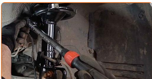
**12** Serra gli elementi di fissaggio che collegano il tirante della barra stabilizzatrice alla barra. Utilizza una chiave a bussola N°16. Utilizza una chiave combinata N°16. Usa una chiave dinamometrica. Serralo fino allo coppia di torsione di 62 Nm.
