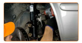
Serra gli elementi di fissaggio che collegano il tirante della barra stabilizzatrice alla barra. Utilizza una chiave combinata N°18. Usa la chiave Torx T40. Usa una chiave dinamometrica. Serralo fino allo coppia di torsione di 85 Nm.
