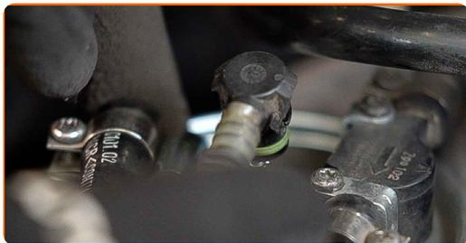
**7** Svita gli elementi di fissaggio che collegano il tubo di rifornimento carburante alla scatola del filtro carburante. Usa un cacciavite Phillips.
