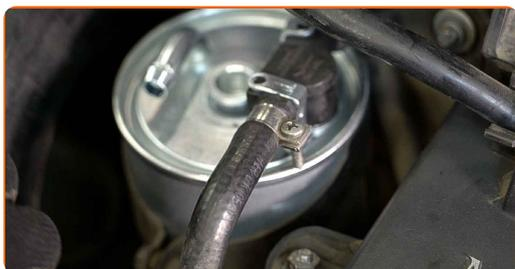
**13** Installa il sensore di pressione carburante.
