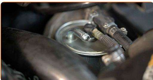
**6** Rimuovi il sensore di pressione carburante. Usa un piede di porco.
