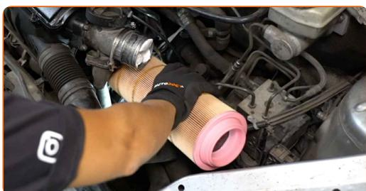
Sostituzione: filtro aria - MERCEDES-BENZ Vaneo (414). Gli esperti di AUTODOC raccomandano:
