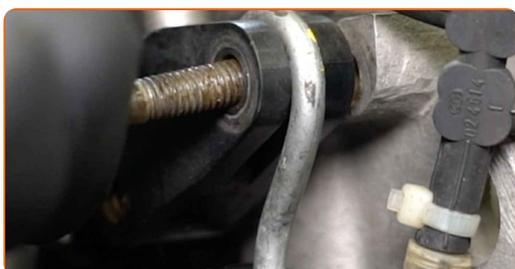
**8** Avvitare il bullone di fissaggio del tendicinghia. Utilizza una chiave combinata N°16 (2 pezzi).
