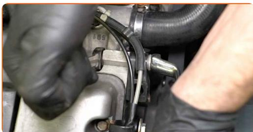
**4** Utilizzare una leva di diametro adeguato per allentare il tendicinghia e rimuovere il bullone di fissaggio. Utilizzare una barra di prolunga a testa quadrata da 3/8".
