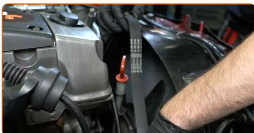
**Sostituzione: cinghia poly-V - MERCEDES-BENZ T1 Pianale piatto/Telaio (602).**
