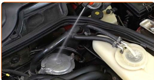
**6** Svitare gli elementi di fissaggio del tappo dell'alloggiamento del filtro dell'olio. Utilizza una chiave a bussola N°13. Usa una chiave a cricchetto.
