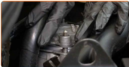
**25** Serrare gli elementi di fissaggio del tappo dell'alloggiamento del filtro dell'olio. Utilizza una chiave a bussola N°13. Usa una chiave dinamometrica. Serralo fino allo coppia di torsione di 25 Nm.
