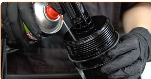
**19** Installa i nuovi o-ring e il nuovo filtro dell'olio alle loro sedi di montaggio sul coperchio del filtro.
