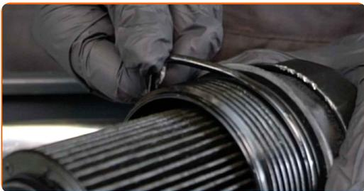
**18** Pulisci il tappo dell'alloggiamento del filtro dell'olio. Usa un detergente spray multiuso.
