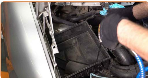
Sostituzione: filtro aria - MERCEDES-BENZ Sprinter 4-T Camion pianale/Telaio (W904). I professionisti raccomandano:
