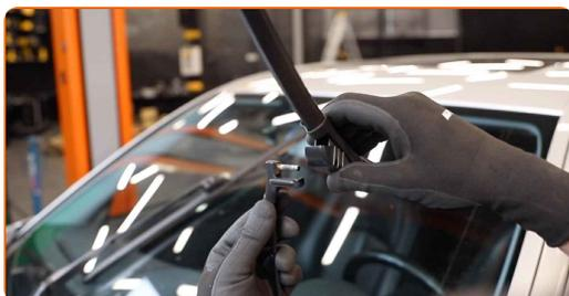
Sostituzione: spazzole tergicristallo - MERCEDES-BENZ Sprinter 4.6-T Bus.
