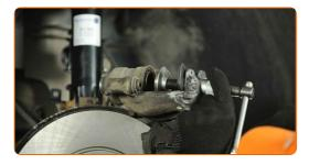
Montare la pinza del freno e fissarla.
