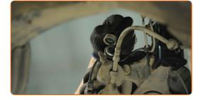
Staccare la presa del sensore di usura delle pastiglie dei freni. Usa delle pinze a becchi lunghi.
