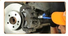
Montare i tappi dei parapolvere delle guide pinza freno. Usa un giravite piatto.
