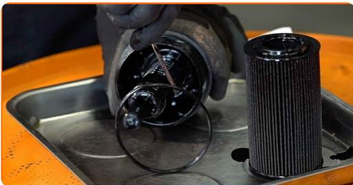
**15** Pulisci il tappo dell'alloggiamento del filtro dell'olio. Usa un detergente spray multiuso.
