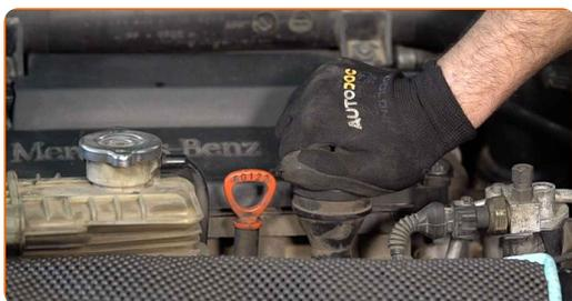
**4** Pulisci la zona del foro di drenaggio della coppa dell'olio. Usa un detergente spray multiuso.
