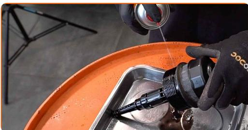
**16** Installa i nuovi o-ring e il nuovo filtro dell'olio alle loro sedi di montaggio sul coperchio del filtro.
