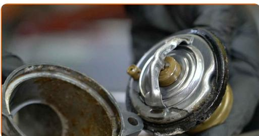
**23** Pulire la sede di montaggio del termostato. Usa una spazzola metallica. Usa un detergente spray multiuso.
