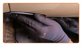
Avvita gli elementi di fissaggio del pannello poggiapiedi laterale del passeggero. Usa la chiave Torx T 20.
