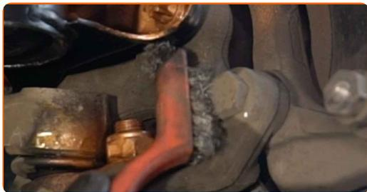
**15** Svitare gli elementi di fissaggio del supporto della pinza del freno. Utilizza una chiave combinata N°18.
