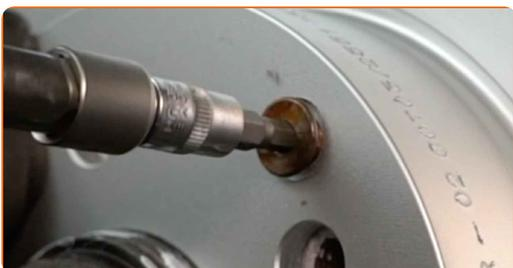
**26** Serrare l'attacco del disco freno. Usa una chiave HEX N.H5. Usa una chiave dinamometrica. Serralo fino alla coppia di torsione di 10 Nm.
