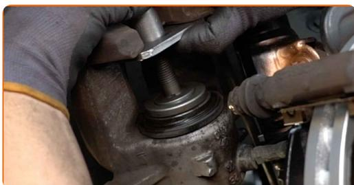
**35** Montare la pinza del freno e fissarla.
