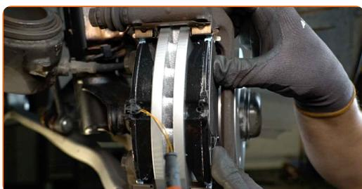
**33** Tratta con del prodotto il pistone della pinza freno. Usare una spazzola pulente in nylon. Usa un pulitore freni.
