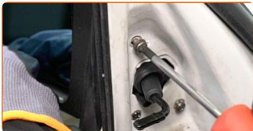
**12** Installare il rivestimento dello specchietto retrovisore laterale.
