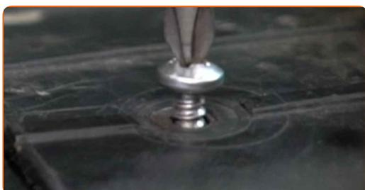
**17** Avvitare gli elementi di fissaggio del tubo di aspirazione. Usa un cacciavite Phillips. Utilizza una chiave a bussola N°10. Usa una chiave a cricchetto.
