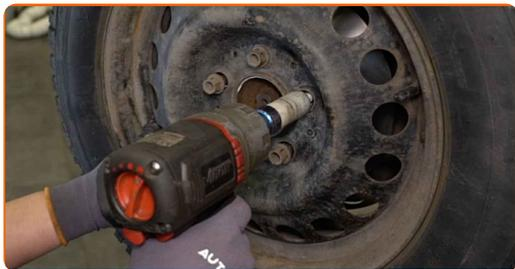
**28** Rimettere il veicolo per terra e, lavorando in ordine incrociato, serrare i bulloni di fissaggio delle ruote. Usa la chiave a bussola per dadi cerchio ruota n.17. Usa una chiave dinamometrica. Serralo fino allo coppia di torsione di 110 Nm.
