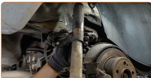
**16** Pulisci le sedi di montaggio dell'ammortizzatore. Usa una spazzola metallica. Usa un detergente spray multiuso.
