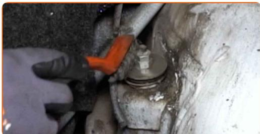
**4** Allenta gli elementi di fissaggio superiori dell'ammortizzatore. Utilizza una chiave combinata N°14 (2 pezzi).
