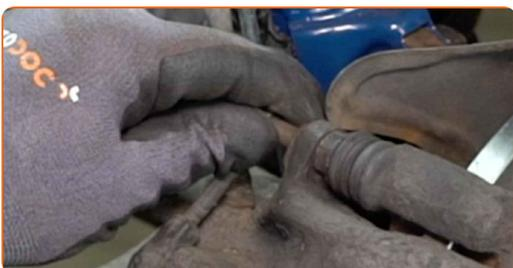
**23** Serra gli elementi di fissaggio della pinza del freno. Utilizza una chiave combinata N°15. Utilizza una chiave a bussola N°13. Usa una chiave dinamometrica. Serralo fino allo coppia di torsione di 35 Nm.
