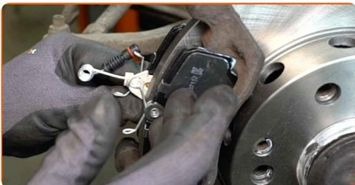
**21** Installare la pinza del freno e fissarla.
