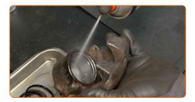
Installare il nuovo anello di tenuta O-ring del pistone della pinza del freno.
