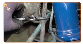
Allentare l'elemento di fissaggio del tubo del freno. Utilizza una chiave combinata N°14.
