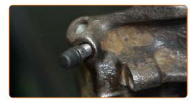
Pulire il supporto della pinza del freno da sporco e polvere. Usa una spazzola metallica. Usa un detergente spray multiuso.
