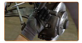
Collega il tubo flessibile del kit di spurgo freno pneumatico alla valvola di spurgo del freno.
