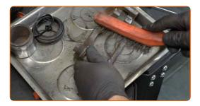
Rimuovere i perni di guida della pinza del freno.
