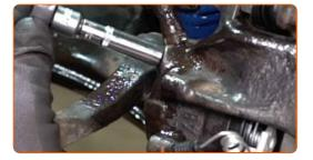
Collega il tappo della vite di spurgo della pinza freno.
