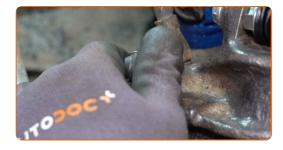
Serra la vite di spurgo della pinza freno. Utilizza una chiave a bussola N°10. Usa una chiave dinamometrica. Serralo fino allo coppia di torsione di 8 Nm.
