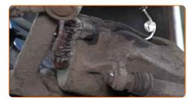
Svitare l'elemento di fissaggio del connettore del sensore di usura delle pastiglie dei freni. Utilizza una chiave combinata N°10.
