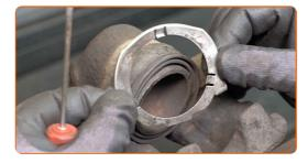
Rimuovere il pistone dall'alloggiamento della pinza del freno.
