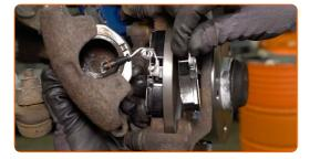
Svitare il tubo flessibile del freno dalla pinza del freno.
