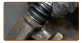
Installare la staffa della pinza del freno.
