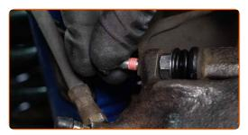
Serra gli elementi di fissaggio della pinza del freno. Utilizza una chiave combinata N°15. Utilizza una chiave a bussola N°13. Usa una chiave dinamometrica. Serralo fino allo coppia di torsione di 35 Nm.
