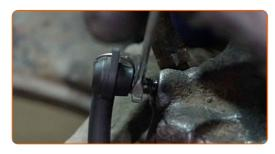
Disconnetti il tubo flessibile del kit di spurgo freno pneumatico.
