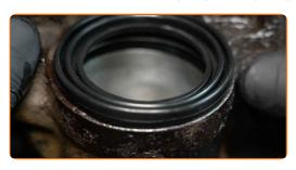
Installare il nuovo pistone della pinza del freno.
