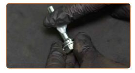
Installa i nuovi parapolveri dei perni guida della pinza del freno.
