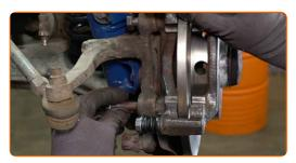
Serrare gli elementi di fissaggio del supporto della pinza del freno. Utilizza una chiave a bussola N°19. Usa una chiave dinamometrica. Serralo fino allo coppia di torsione di 115 Nm.
