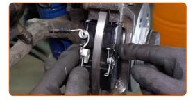
Installare la pinza del freno e fissarla.
