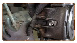
Avvitare l'elemento di fissaggio del connettore del sensore di usura delle pastiglie dei freni. Utilizza una chiave combinata N°10.
