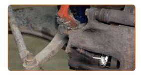
Stringi il tubo del freno usando una fascetta di fissaggio del tubo freni.
