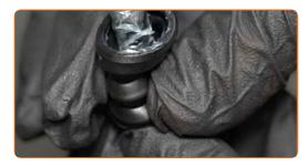
Installare i perni di guida della pinza del freno.
