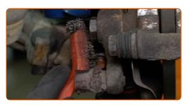
Svitare gli elementi di fissaggio del supporto della pinza del freno. Utilizza una chiave a bussola N°19. Usa una chiave a cricchetto.
