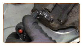
Pulire le sedi di montaggio del pistone e dei relativi componenti. Usa una spazzola metallica. Usa un detergente spray multiuso.
