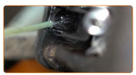
Collegare il connettore del sensore di usura delle pastiglie dei freni.
