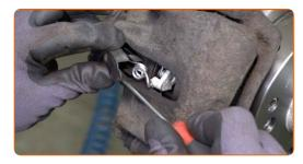
Pulire l'elemento di fissaggio del connettore del sensore di usura delle pastiglie dei freni. Usa una spazzola metallica. Usa lo spray WD-40.
