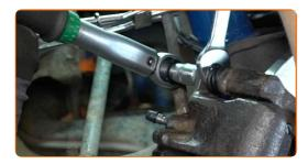
Avvita gli elementi di fissaggio che collegano il tubo flessibile del freno alla pinza del freno. Utilizza una chiave combinata N°14. Usa una chiave dinamometrica. Serralo fino allo coppia di torsione di 18 Nm.
