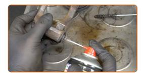
Tratta i perni guida della pinza del freno con il prodotto. Usa il grasso per il perno guida della pinza del freno.
