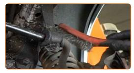
Svita le staffe di fissaggio delle boccole dello stabilizzatore. Utilizza una chiave combinata N°13. Utilizza una chiave a bussola N°13. Usa una chiave a cricchetto.
