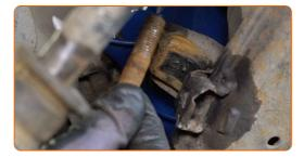
Separare il giunto sferico dal fuso a snodo dello sterzo. Usa uno scalpello piatto per la lavorazione dei metalli. Usa un martello. Usa un piede di porco.
