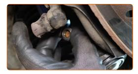
Serrare l'elemento di fissaggio che collega il giunto sferico al fuso a snodo dello sterzo. Utilizza una chiave combinata N°19. Utilizza una chiave a bussola N°19. Usa una chiave dinamometrica. Serralo fino allo coppia di torsione di 75 Nm.
