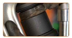
Pulisci la sede di montaggio del giunto sferico. Usa una spazzola metallica. Usa un detergente spray multiuso.
