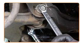
Serra gli elementi di fissaggio posteriori del braccio di controllo. Utilizza una chiave combinata N°22. Utilizza una chiave a bussola N°22. Usa una chiave dinamometrica. Serralo fino allo coppia di torsione di 120 Nm.
