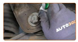
Svitare il fissaggio anteriore del braccio di controllo. Utilizza una chiave combinata N°22. Utilizza una chiave a bussola N°22. Usa una chiave a cricchetto.
