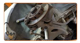
Installa il compressore per molle sulla molla elicoidale.
