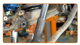
Per serrare correttamente i fissaggi, è necessario sollevare i componenti della sospensione fino a raggiungere la relativa posizione di lavoro.
