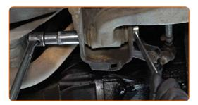
Svitare l'elemento di fissaggio che collega il giunto sferico al fuso a snodo dello sterzo. Utilizza una chiave combinata N°19. Utilizza una chiave a bussola N°19. Usa una chiave a cricchetto.
