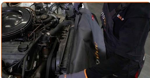
**3** Svitare l'elemento di fissaggio che collega il pistone ammortizzatore del cofano alla carrozzeria. Utilizza una chiave combinata N°13 (2 pezzi).
