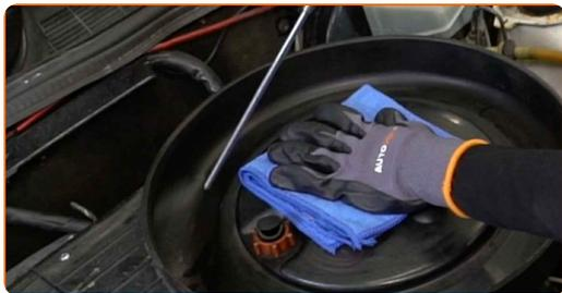
**8** Inserire un nuovo elemento filtrante nell'alloggiamento del filtro.
