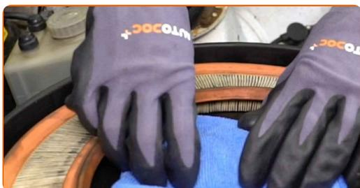
**6** Rimuovere l'elemento filtrante dall'alloggiamento del filtro.
