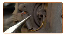
Pulire gli elementi di fissaggio del cablaggio del sensore di usura delle pastiglie dei freni. Usa una spazzola metallica. Usa lo spray WD-40.
