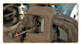
Serra gli elementi di fissaggio della pinza del freno. Usa una chiave HEX N.H7. Usa una chiave dinamometrica. Serralo fino allo coppia di torsione di 25 Nm.
