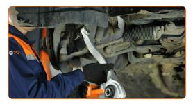
Sostituzione: braccio inferiore anteriore - MERCEDES-BENZ CLS Coupe (C219). I professionisti raccomandano:
