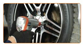
Rimettere il veicolo per terra e, lavorando in ordine incrociato, serrare i bulloni di fissaggio delle ruote. Usa la chiave a bussola per dadi cerchio ruota n.17. Usa una chiave dinamometrica. Serralo fino allo coppia di torsione di 120 Nm.
