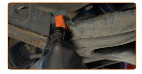
Svitare l'elemento che fissa il braccio al telaio di base. Utilizza una chiave combinata N°21. Utilizza una chiave a bussola N°E18. Usa una chiave a cricchetto.
