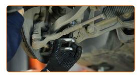
Pulisci gli elementi di fissaggio che collegano il braccio di controllo al sottotelaio. Usa una spazzola metallica. Usa lo spray WD-40.
